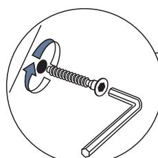
3. Далее соедините вязку №2 с задней стенкой №5 евровинтами. На вязки №1 и №2 с помощью шурупов 4x16 закрепите уголки 20x20, как показано на схеме 2. Рекомендуем устанавливать уголки 20x20 на расстоянии 130-150 мм от края вязки.
