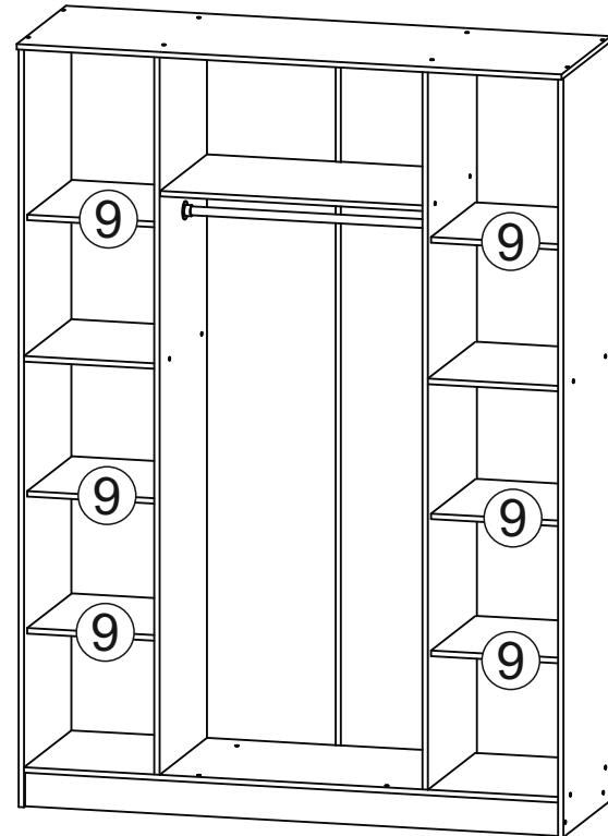
8. На створки №№10,11 привернуть накладные петли, используя шурупы 4x16. Затем привернуть створки с петлями к боковинам №№1,2 и перегородкам №№3,4. Установить ручки с помощью винтов 3,5x25 (схема 6). Выровнять створки, как показано на иллюстрации на стр. 2.
