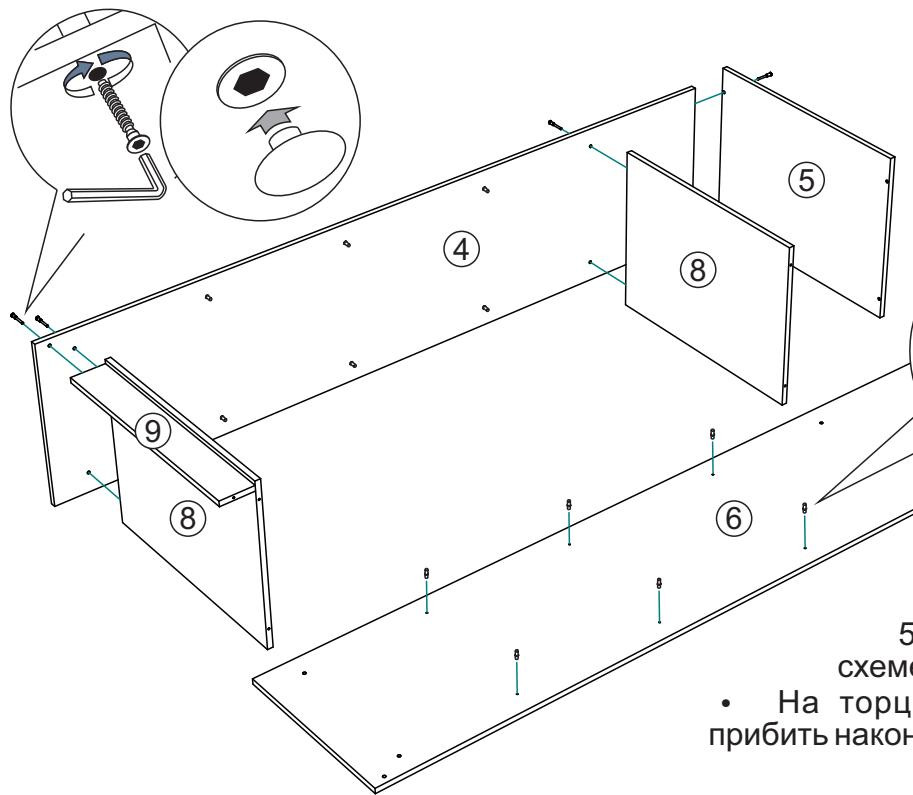
1. Сборка производится горизонтально, тыльной стороной вниз. Предварительно необходимо отобрать боковины, ориентируясь на сверловку.
