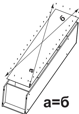
2. Чтобы установить заднюю стенку (деталь №2), необходимо собранную конструкцию перевернуть лицевой стороной вниз. Замерить, с помощью рулетки, и уронять диагонали. Наложить заднюю стенку. Аккуратно, не нарушая диагоналей, прибить ЛДВП гвоздями, шагом 130-150 мм.
