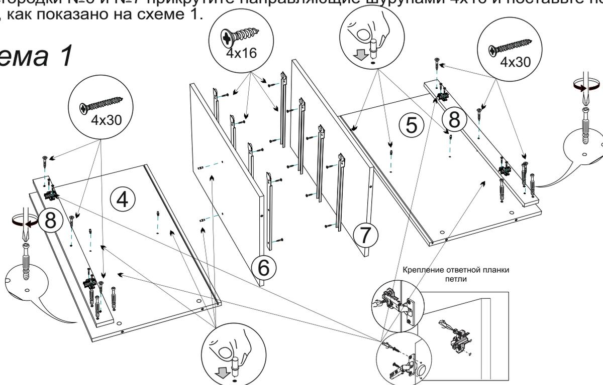
3. Соберите каркас комода. Для этого соедините боковины №4 и №5, и перегородки №6 и №7 с планкой №3 и панелью ЗД №17 при помощи эксцентриковых стяжек, затем прикрутите евровинтами крышку №2 и планку №3. Вставьте заднюю стенку (ЛДВП) №15 в пазы на боковинах и крышке, предварительно соединив его брусами №22 и №23. Затем присоедините крышку №1 при помощи эксцентриков. Прикрутите шурупами 4x30 планки №10 и №11, как показано на схеме 2.
