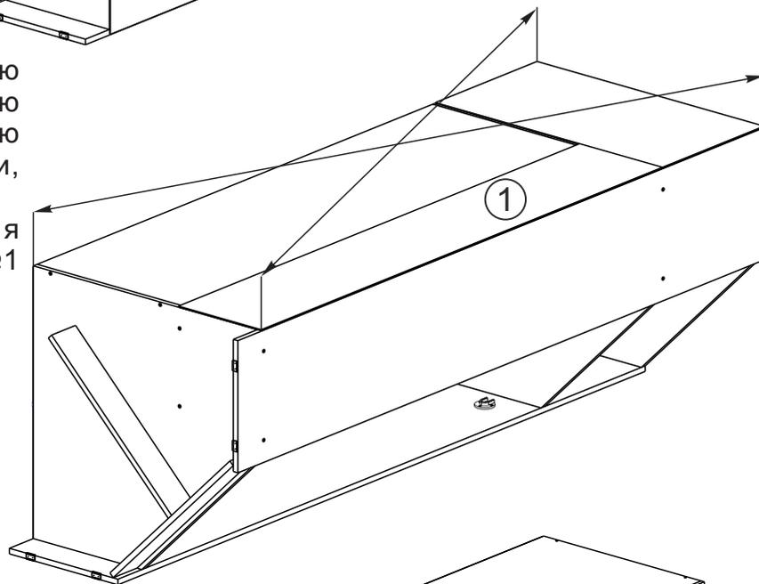
9. Далее необходимо собранную конструкцию поставить на заранее определённое место. Установить штангу и полки, а также створку. Отрегулировать зазоры, используя схему представленную выше.
