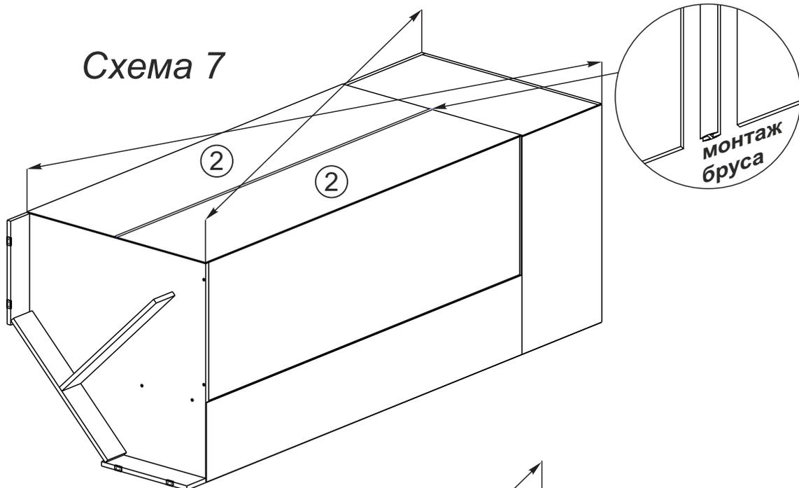
Далее необходимо собранную конструкцию перевернуть на другую боковину, замерить с помощью рулетки, и уровнять диагонали, наложить заднюю стенку.
